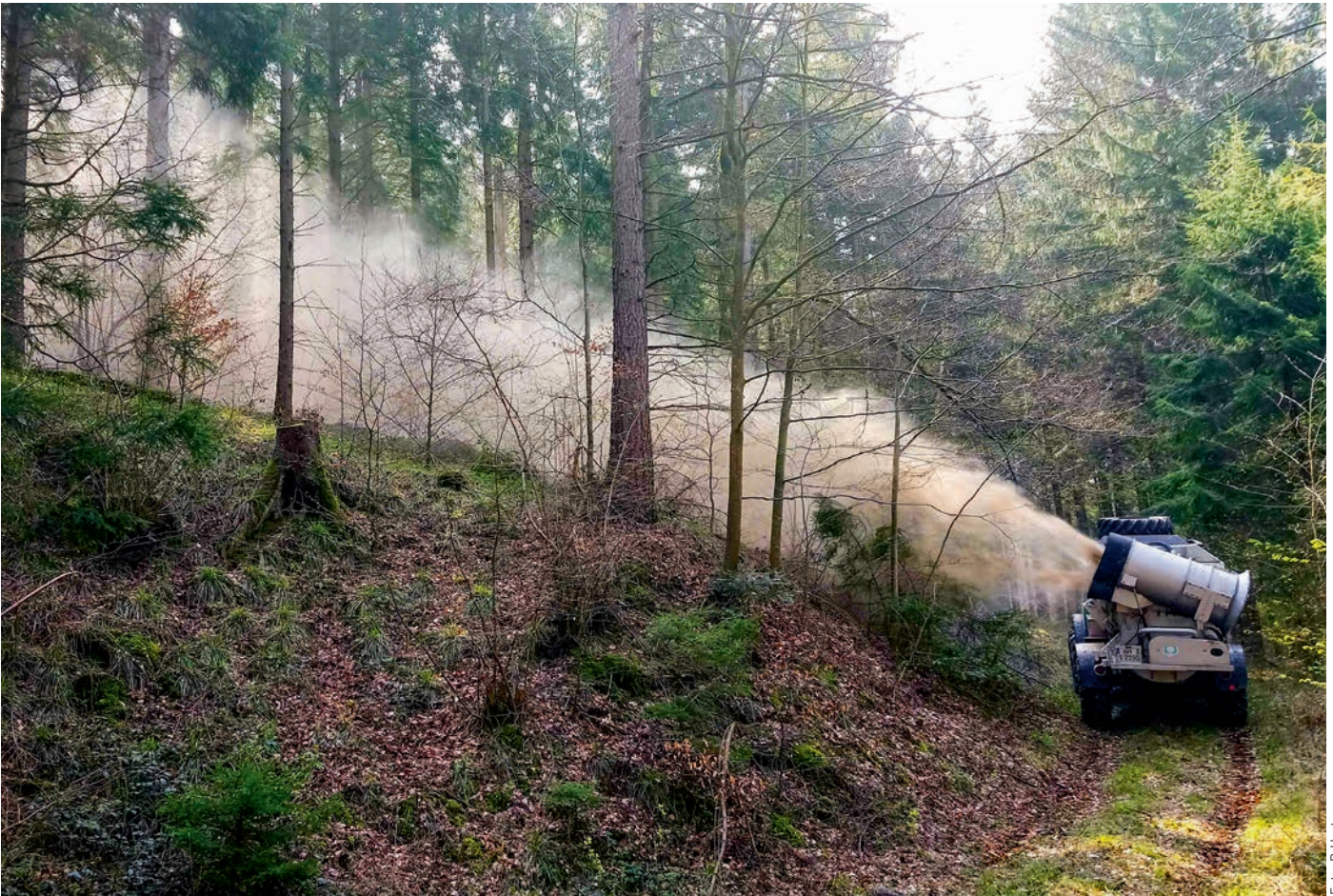
Abb. 7: Spezialisiertes Verblasegerät zur kostengünstigen terrestrischen Ausbringung von angefeuchtetem Kalk
